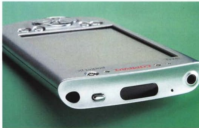
Vicino alla porta infrarossi, troviamo sia il connettore minijack per la cuffia stereofonica, che la sede del piccolo pennino adibito all'inserimento dei dati.
